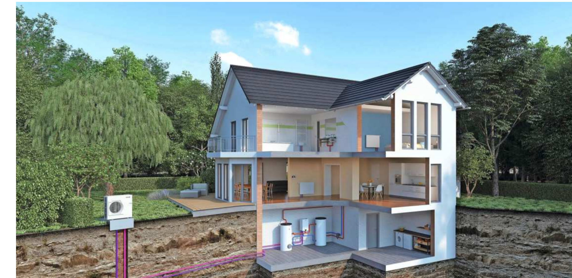
Vorbild für alle Häuser? Schematische Darstellung einer Wärmepumpenheizung
